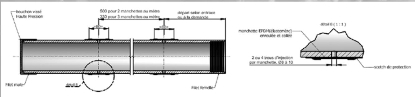
Principe d'un tube à manchette avec protection métallique :
